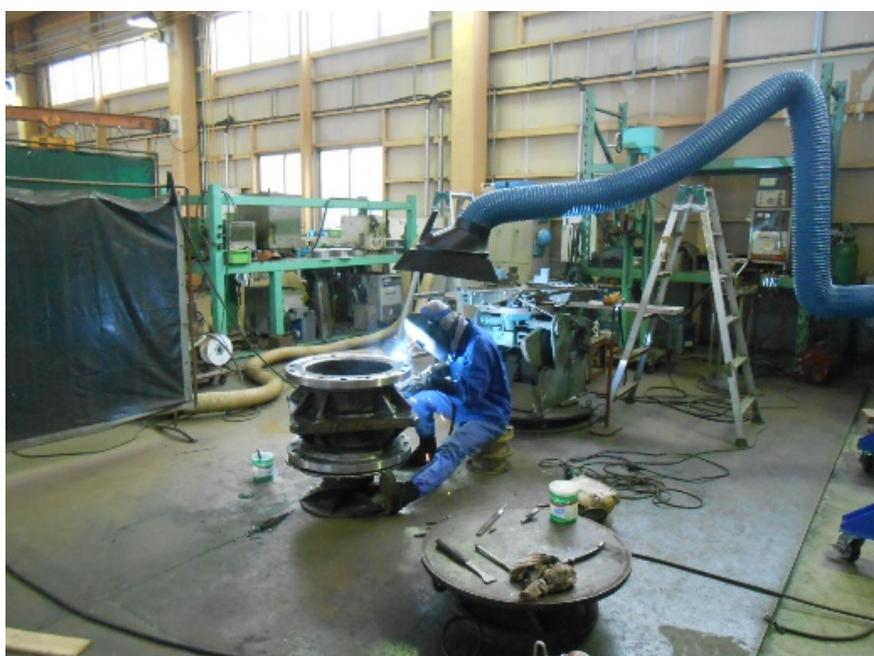
集塵装置を設置し、集塵装置に自在アームスタンドフードを取付稼働範囲を大きく取れるようにした。
