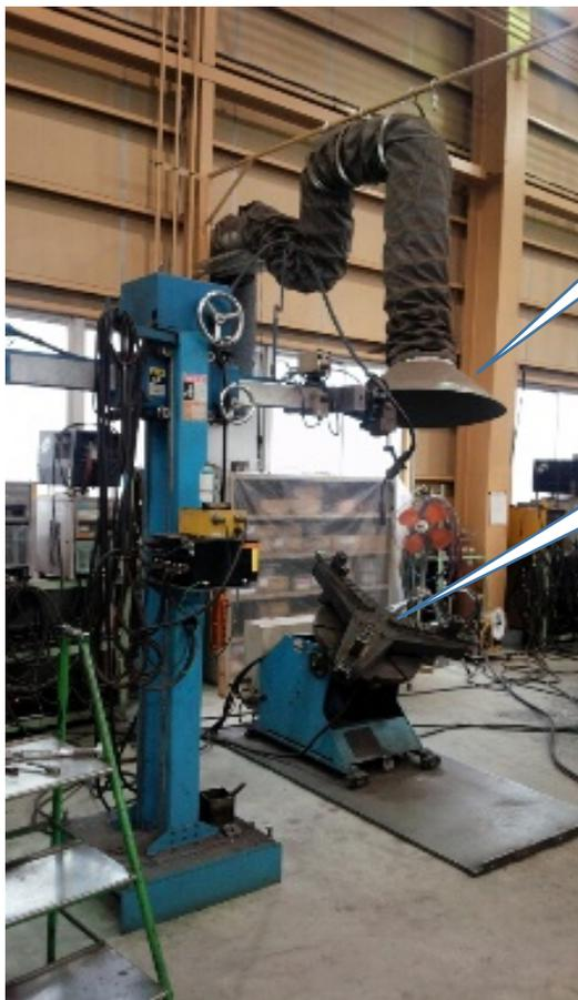
集塵フードは、天吊りにして半自動溶接機の上部にセット
